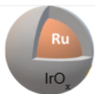
Figura 10. Material nanoestructurado tipo Core-Shell \text{RuO}_2@\text{IrO}_x . Adaptado de (Lv et al., 2020)
